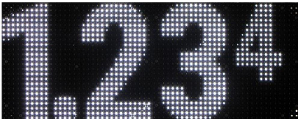
*Illustrazione 2: Combinazione orizzontale di due matrici per formare un testo di altezza 24cm*
